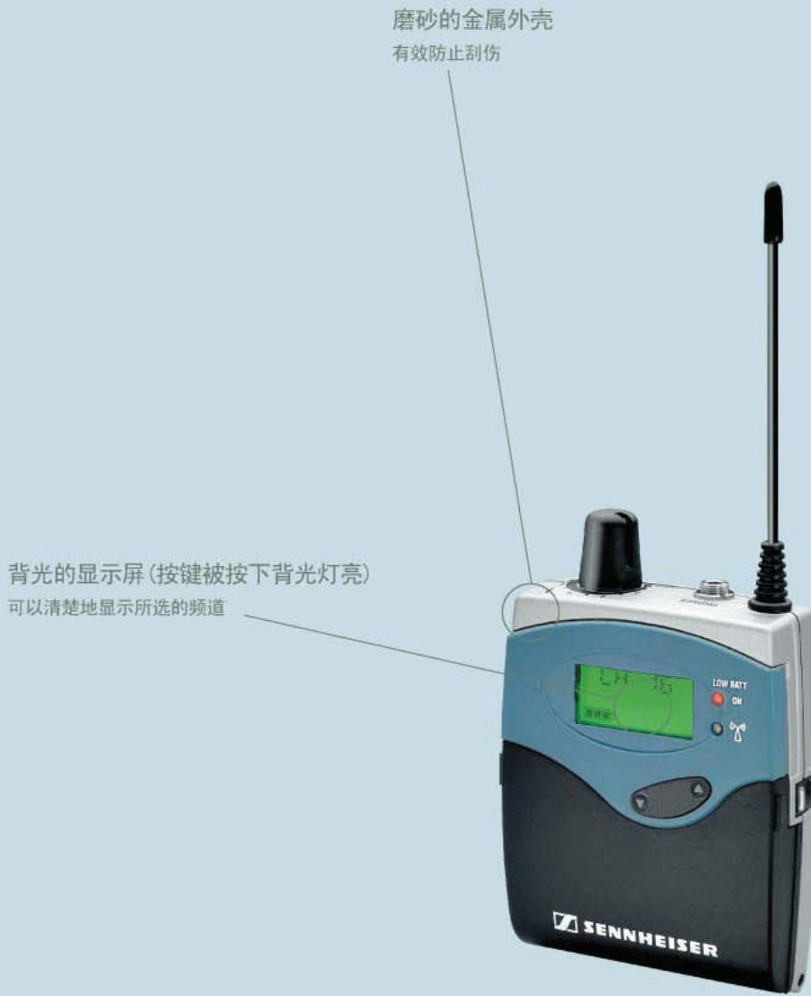
**EK 1038** 这款具有磨砂金属感的接收机，特别为旅游、参观、同声传译的使用而设计的，可以与Sennheiser的多种型号耳机自由搭配使用。UHF的传输技术确保信号能被优质传送，令讲解员和接收者的操作倍感轻松和方便。接收机上On/Off的开关可以轻松地控制音量，Up/Down按钮可以改变频道。背光的显示屏可以清楚地显示所选的频道，用“Lock”锁机功能可以防止频道的不小心切换，此时每个接收机的音量仍可以根据个人需要，方便的控制。
